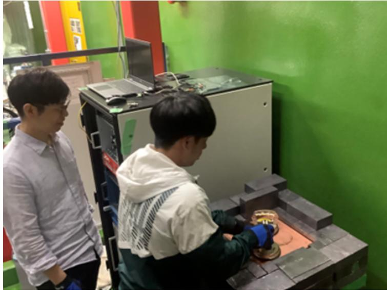
図 26: 神岡の地下実験室内の鉛シールドを用いたバックグラウンド調査実験の様子。
